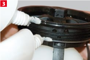
Dichtungen an der Rückstaeinheit einfetten
